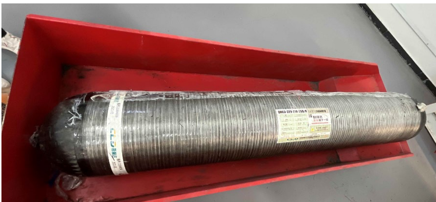
图 4-6 210 L 气瓶试验结束整体失效情况图
